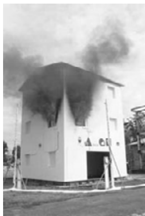
Figura 4.18: Simulazione di incendio presso il Building Research Institute (Progetto SOFIE - Tsukuba - Giappone, 2007)
