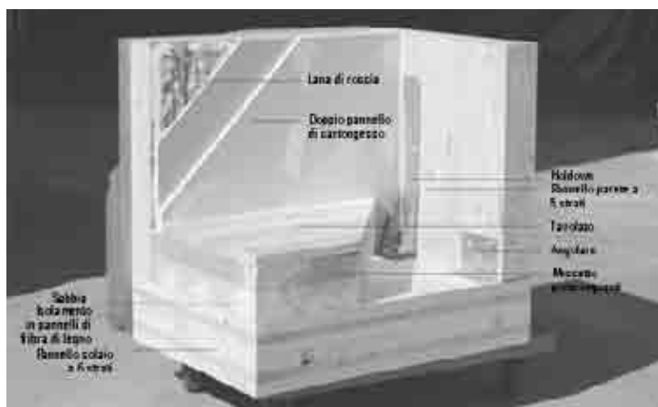
Figura 3.16: Pacchetti costruttivi per parete e solaio.
