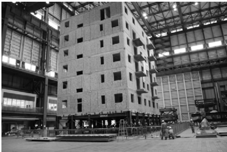
Figura 3.5: Edificio di 6 piani a struttura di legno sottoposto a prove sismiche presso la tavola vibrante E-Defence a Miki, Kobe, Giappone (Luglio 2009, per gentile concessione del Prof. J.Van De Lindt).
